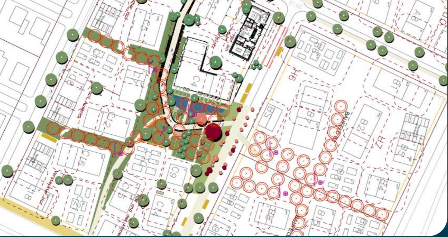
ecovillage mit Erdwärmesondenfeld
